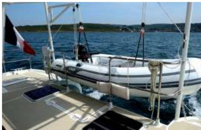
La construction de ce bateau est du genre costaud, comme le montre le support de panneaux solaires, les bossoirs d'annexe et le mât-articulé de relevage du hors-bord...
